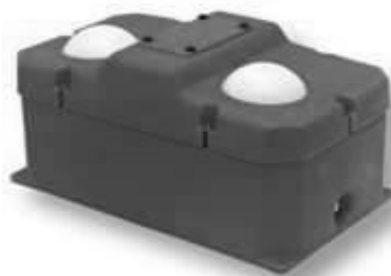
Рисунок 3.13 – Поилка модель 640 Поилка защищена от попадания корма в воду. Зимой не замерзает за счет тепла земли. Имеет двойные теплоизолированные стенки из пластмассы. Обеспечивает водой от 20 до 40 животных.
