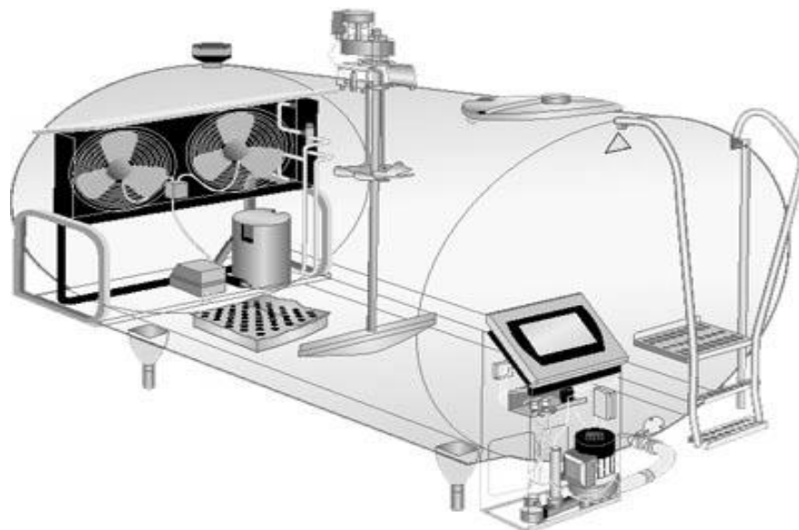
Рисунок 6.31 – охладитель с системой электронного контроля RL 20
