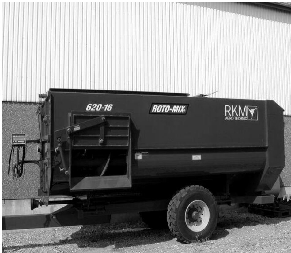
Рисунок 4.25 – Горизонтальный смеситель - кормораздатчик ROTO-MIX объемом от 11 м 3 до 40 м 3
