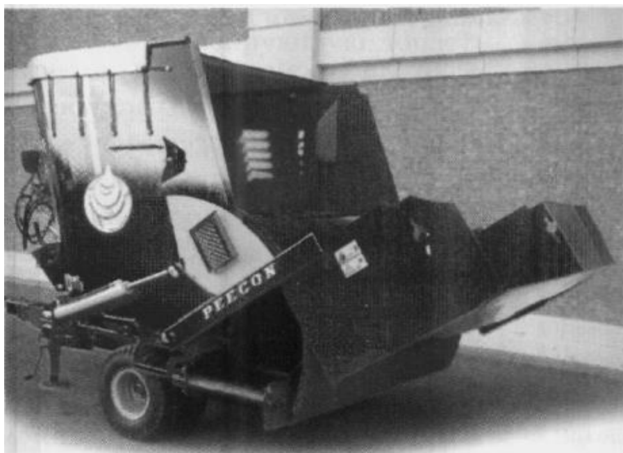
Рисунок 4.29 – Смеситель-кормораздатчик Biga с загрузочным устройством в виде гидрофицированного борта
