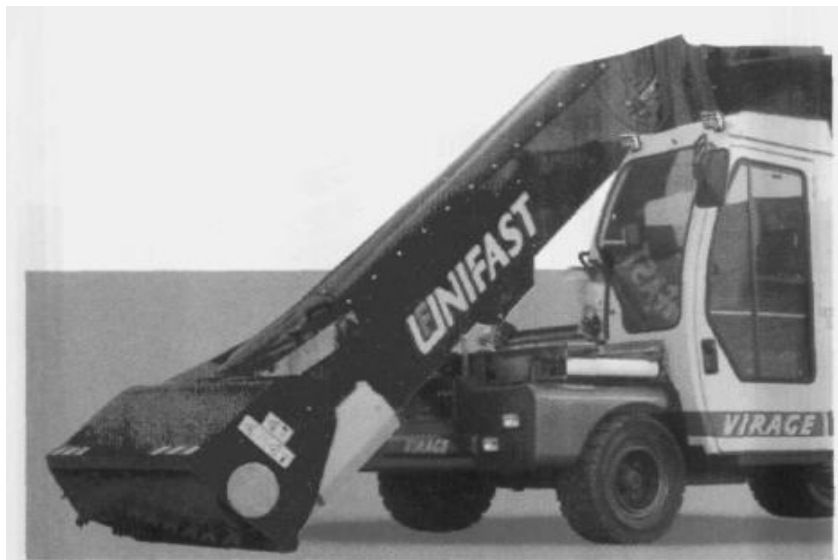
Рисунок 4.31 – Самоходный смеситель-кормораздатчик Virage фирмы «Unifast» с загрузочным устройством в виде фрезы
