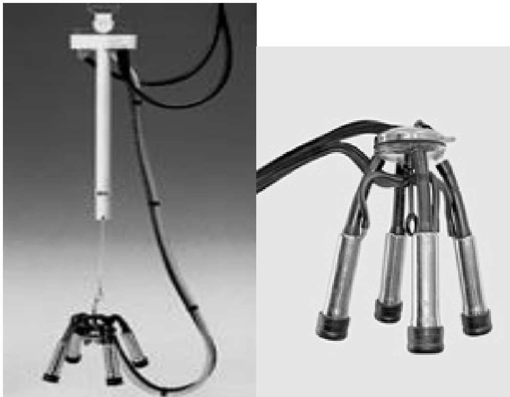
Рисунок 6.16 – Коллектор и доильный аппарат UNIFLOW 3
