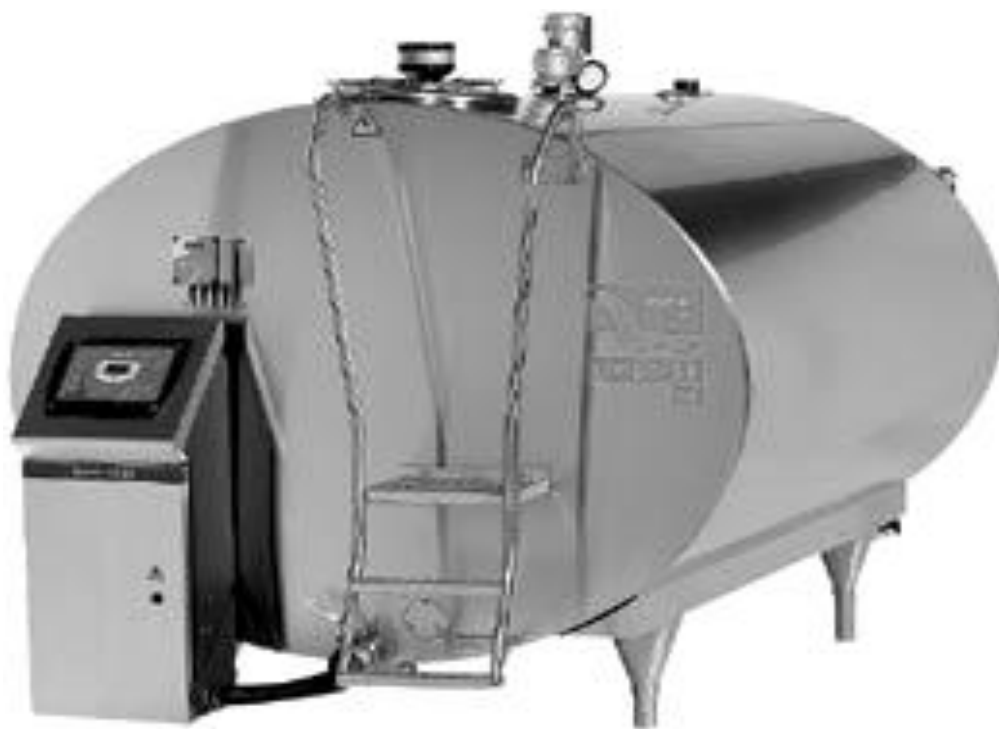
Рисунок 6.30 - FIRST SE, вместимость от 1700 л до 30000 л, эллиптическая цистерна закрытого типа, с устройством автоматической промывки и электронным регулятором охлаждения
