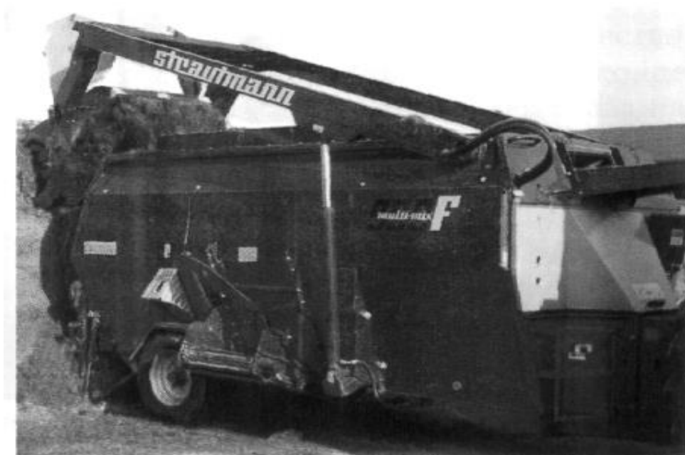
Рисунок 4.30 – Кормосмеситель - раздатчик Multi-Mix фирмы «Strautmann» с загрузочным устройством в виде фрезы
